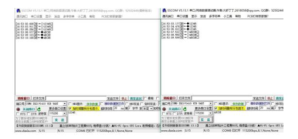
简要原理说明: A和B的空中速率和物理信道必须一致;波特率与下接串口设备需一致;设备A指定ID:1和透传地址:2,则设备2指定ID:1和透传地址:01。
