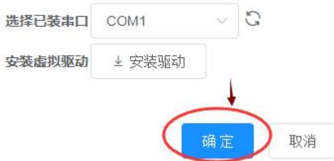
4、点击确定后，会开启串口透传通道，透传成功提示后，即可进入串口透传状态；
