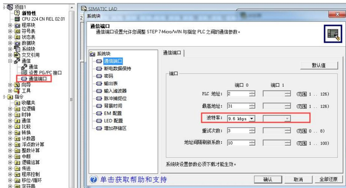
7、点击通信，双击调制解调器连接，设置—添加—新建一个默认连接，配置属性：COM 端口，即为安装的虚拟串口号，9600 8 偶校验，点击确定。
