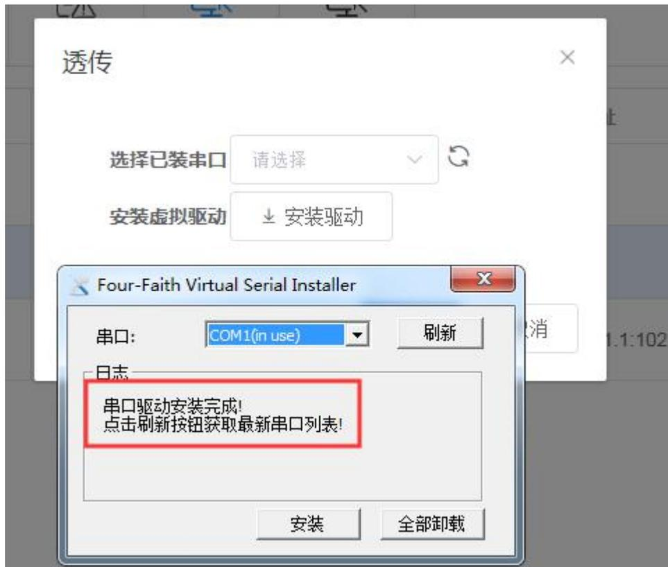
3、选择已安装的串口对，如下图 COM1-COM101 一对虚拟串口对，选择 COM1
