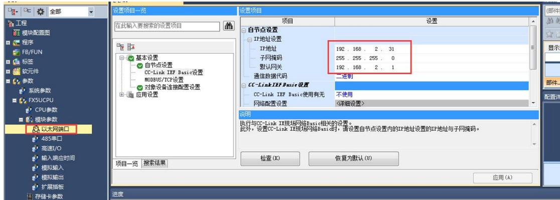
2、注： 如果 PLC 上只连接了 1 个网关， 则只需查询 IP 地址后配置到网关上即可， 端口默认 5562， 若是连接了其他设备， 如触摸屏等， 则需进行如下设置；
